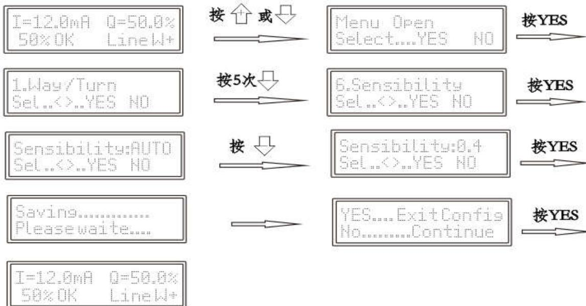
4. 反馈信号正反输出设置，即阀位 0~100%对应输出 4~20mA 信号，可以修改为 0~100%对应 20~4mA 输出。
