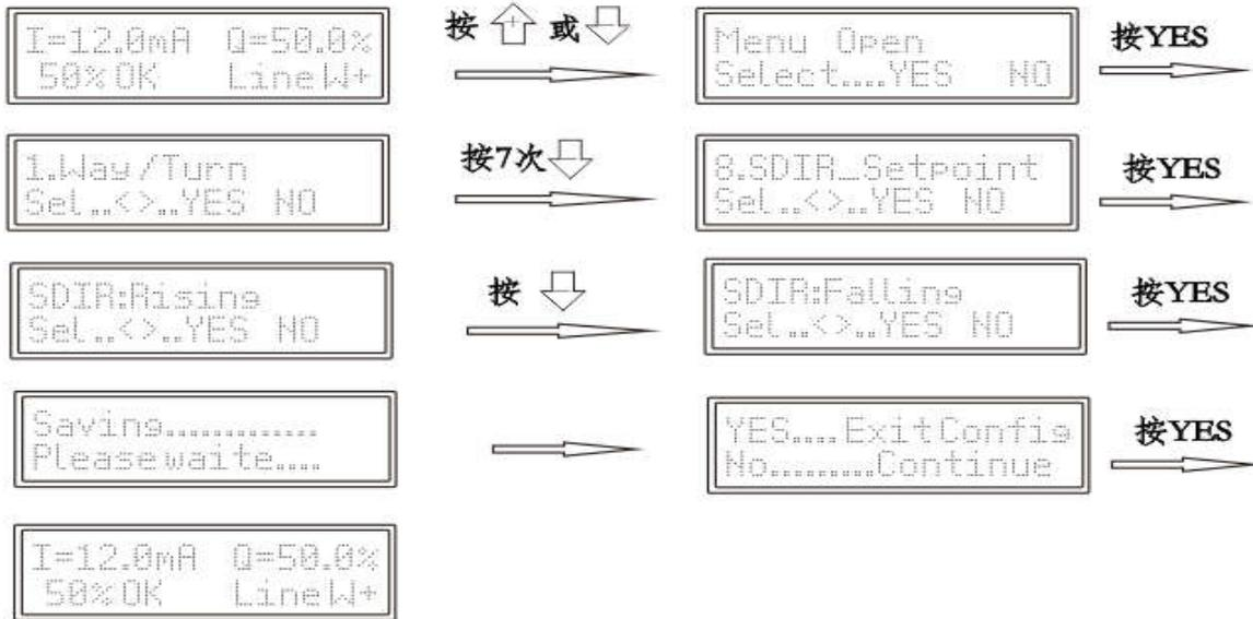
2. 显示屏显示阀位方向设置(参数项为 YDIR\_Setpoint), 默认为 Rising, 即 4~20mA 对应 0~100%显示, 可改为 Falling, 即 4~20mA 对应 100%~0%显示。方法如下:
