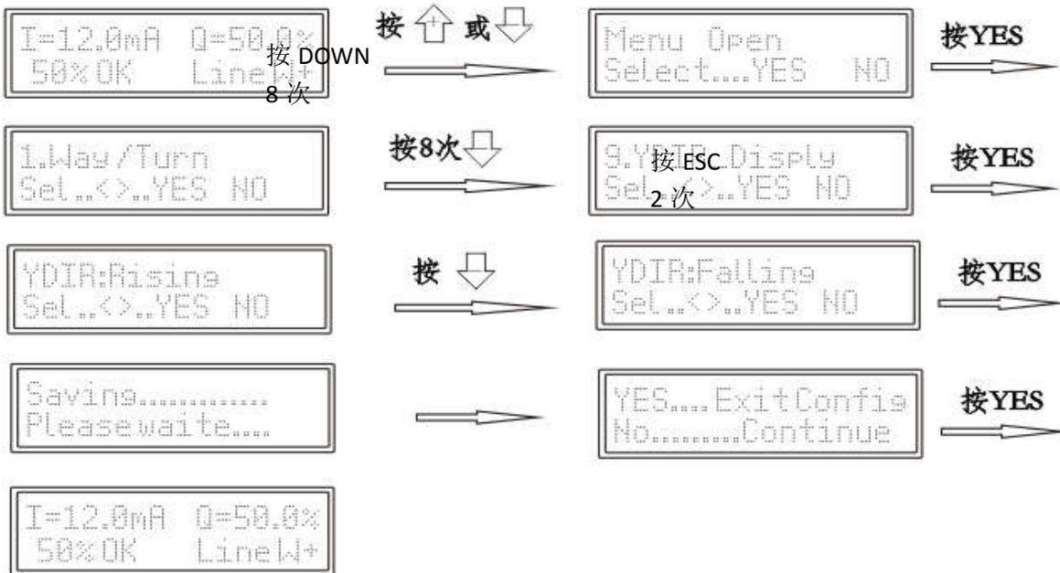
注意, 对于气开阀和气关阀, 设置 SDIR 和 YDIR 的效果不一样, 两个参数的设置效果如下图表所示, 用户可根据实际要求进行设置:
